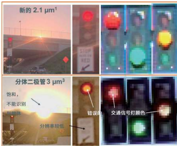
60 度视场 RGGB 1920X1536, 新的 2.1 \mu\text{m} (无滤镜或校正, Devware 颜色处理) 与 3 \mu\text{m} 分体二极管 (启用过饱和校正, GWSISP 颜色处理) 对比
