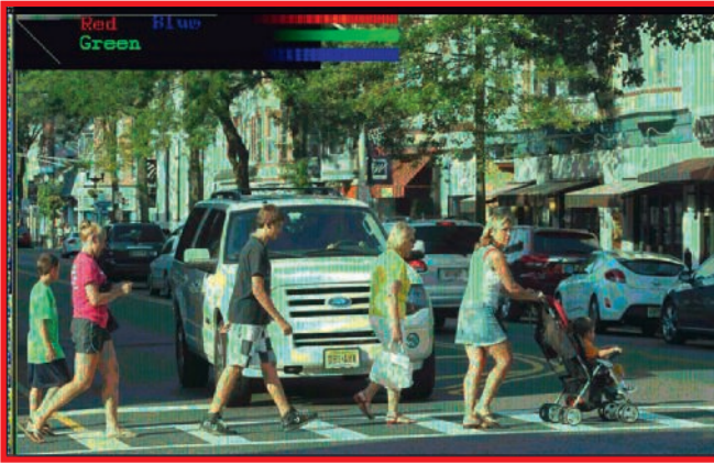
Bild 4: So zeigen sich Fehler in der Zeilenadressierungslogik eines Bildsensors im Fahrzeug.
