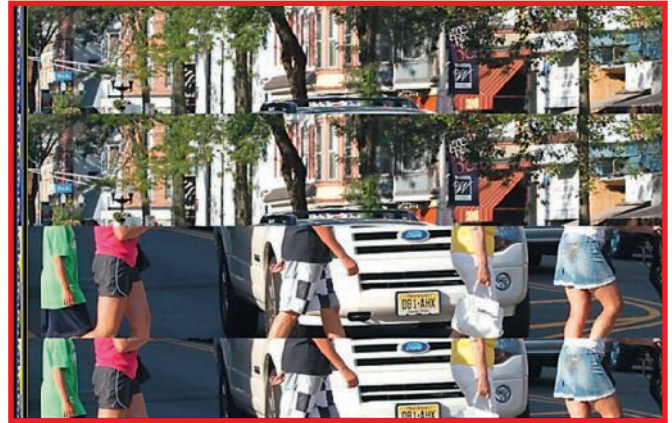
Bild 5: Diese Art von Farbfehlern im Bild entstehen beispielsweise durch eine Störung in der Bild-Pipeline.
