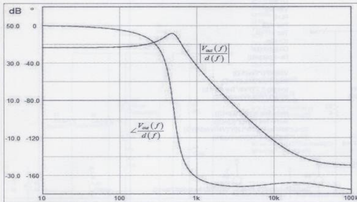
圖3 兩個電路的波德圖完全重疊，驗證了第一步。
