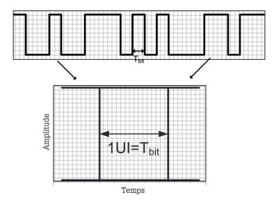
Ce diagramme est celui d'un signal idéal avec des fronts montants et descendants verticaux et une amplitude constante.
