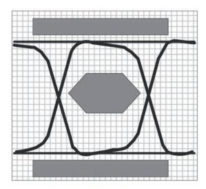
Le masque de conformité comprend des bornes de temps et d'amplitude et permet de vérifier rapidement la qualité du signal.
