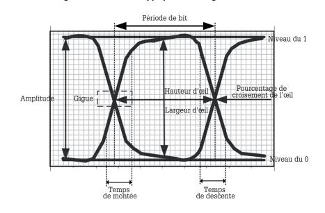
Figure 3.- Mesures typiques du diagramme de l'œil
