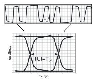
Les signaux numériques « réels » souffrent d'altérations – atténuation, bruit, interférences – qui se reflètent dans le diagramme de l'œil.
