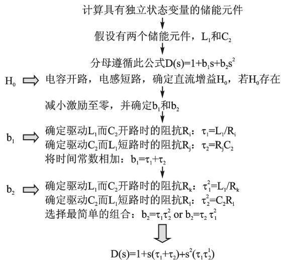
图2 该流程图解释了用于确定电路时间常数的方法
