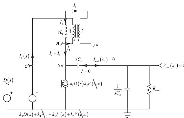
图 18 在  $s=s_z$  的特定条件下, 观察变形的电路, 无信号响应
