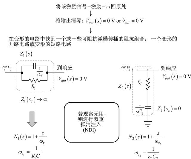
图 1 这个流程图将指导您用最简单的方法确定零点,在观察无用时,将需要进行双重抵消注入或 NDI
