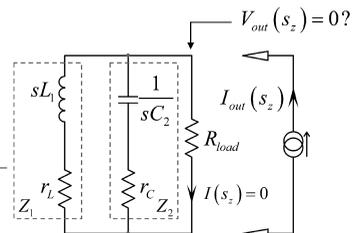
图8 如果阻抗  $Z_1$  或  $Z_2$  转换为短路,响应  $V_{out}$  为无信号输出
