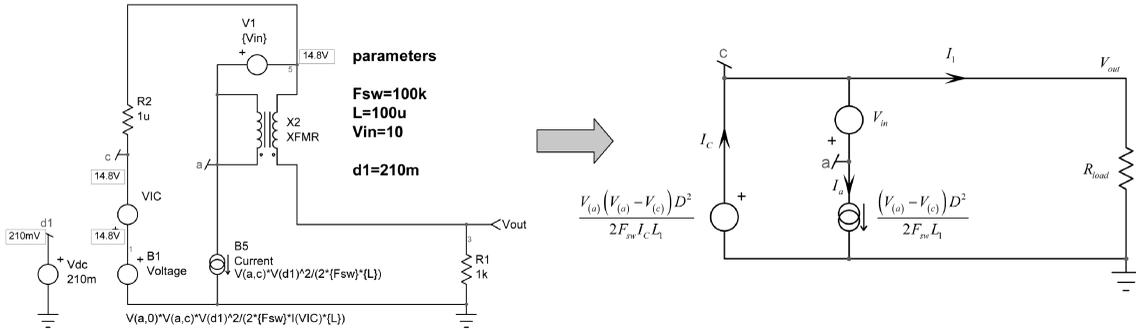
图 14 这是用来确定准静态增益  $H_0$  的最终直流电路
