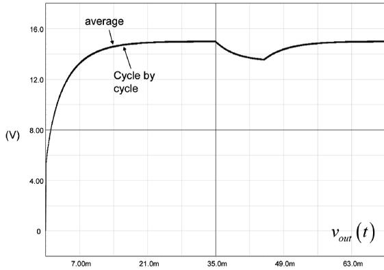
图 12 平均模型与逐周期模型的瞬态响应完全符合
