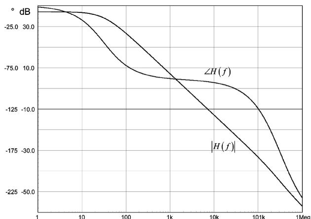
图 21 DCM PWM 开关和 CoPEC DCM 模型提供相同的动态响应
