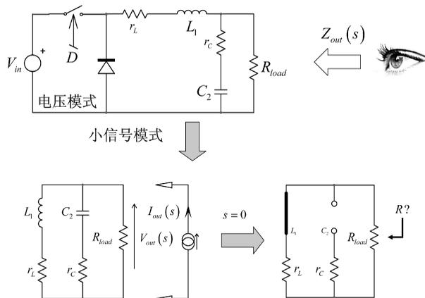
图7 工作于 CCM 的降压转换器的输出阻抗的确定是一个很好的例子,演示了 FACTs 如何简化分析立即确定这两个阻抗的根:
