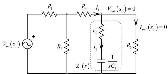
图6 在这变形的电路中,当串联的  $r_c$  和  $C_1$  转化为变形的短路,响应消失,  $R_3$  中无电流流过
