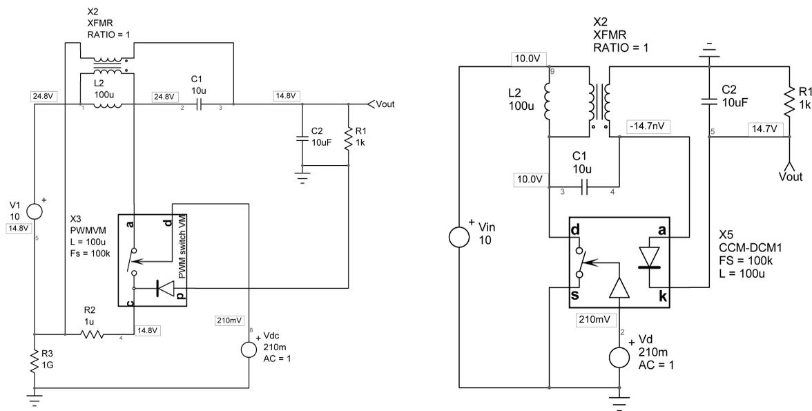
图 20 CoPEC 平均模型包括单独的开关和二极管连接
