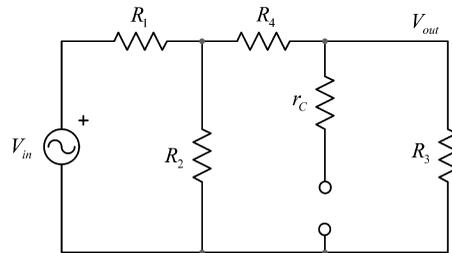
图5 断开直流电路中的电容器, 计算简单的电阻配置的传递函数
