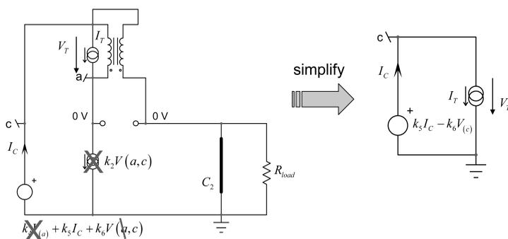
图 17 二阶系数设置储能元件之一处于其高频状态(C<sub>2</sub>), 同时您可确定电感两端的电阻
