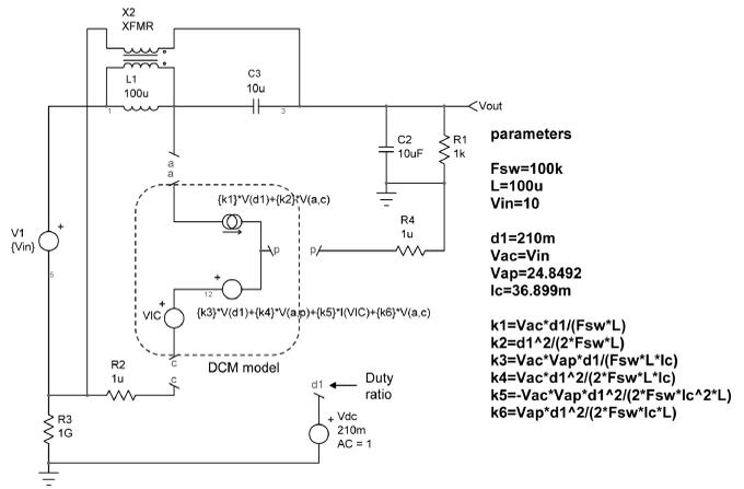
图 13 这是工作在 DCM 模式的 SEPIC 的小信号模型,节点 d1 是占空比偏差和注入点,所有小信号系数都自动出现在参数窗口
