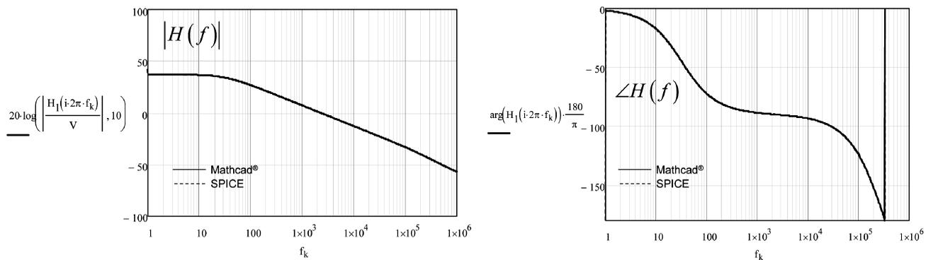
图 19 Mathcad 和 SPICE 提供完全相同的响应(曲线完美叠加)
