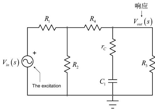
图3 确定电路的时间常数需要将激励源设为0, 并观察从电路中暂时移除的能量存储元件所提供的电阻
