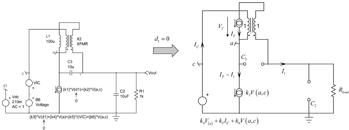
图 15 将激励源减为 0 有助于简化电路，在此我们从驱动电感  $L_1$  的阻抗开始
