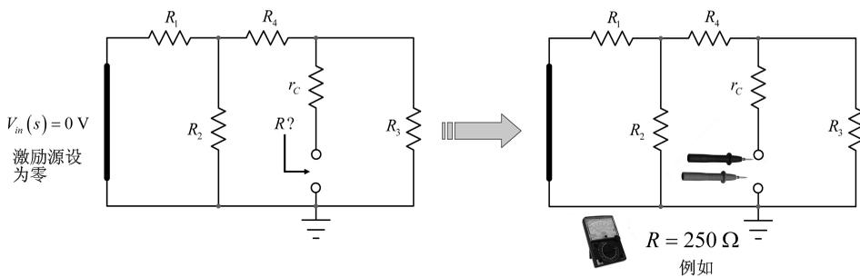
图4 由短路代替0V源后确定电容器端的电阻
