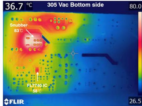
Figure 21.  $V_{IN} = 305 V_{AC}$
