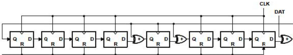
Figure 11. 8-Bit CRC Generator Circuit ( $X^8 + X^5 + X^4 + 1$ )
