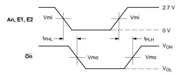
**WAVEFORM 2: PROPAGATION DELAYS FOR NON-INVERTING OUTPUTS**
