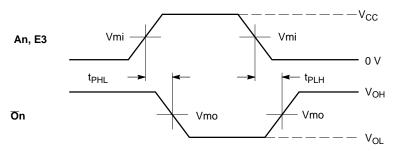
**WAVEFORM 1: PROPAGATION DELAYS FOR INVERTING OUTPUTS**
