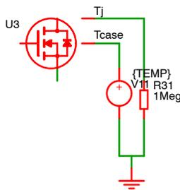
Figure 28. Five-Pin Thermal Simulation Model for MOSFET Die
