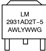
D2PAK D2T SUFFIX CASE 936
