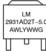
D2PAK D2T SUFFIX CASE 936
