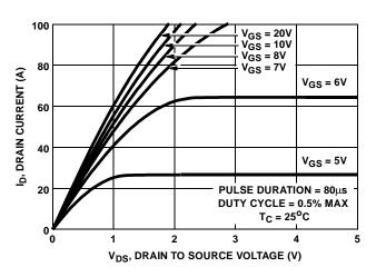
FIGURE 7. SATURATION CHARACTERISTICS
