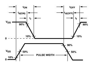
FIGURE 19. RESISTIVE SWITCHING WAVEFORMS
