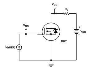
FIGURE 16. GATE CHARGE TEST CIRCUIT
