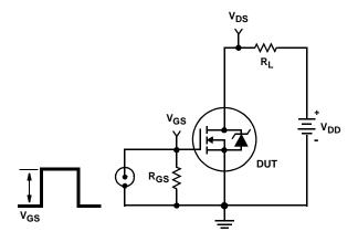
FIGURE 18. SWITCHING TIME TEST CIRCUIT
