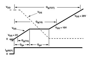
FIGURE 17. GATE CHARGE WAVEFORM
