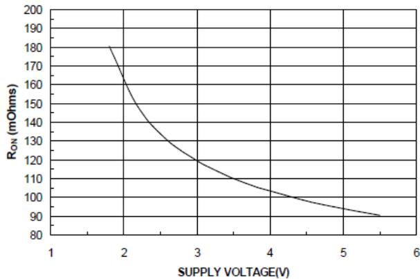
Figure 8. R<sub>ON</sub> vs. V<sub>IN</sub>
