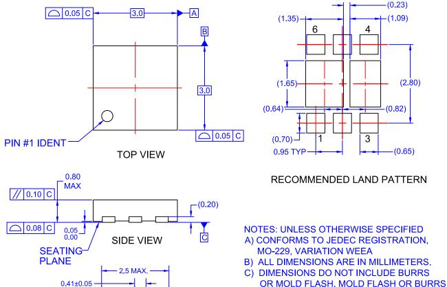
0.41±0.05 1.17±0.05 0.82±0.05 DOES NOT EXCEED 0.10MM. 0.61±0.05 0.79±0.05 D) DIMENSIONING AND TOLERANCING PER 0.45 0.20 3 ASME Y14.5M-2009. PIN #1 IDENT 1.7 MAX. 0.10M C A B 0.2 MIN 0.05M C 6 0.45 0.95 1.90
