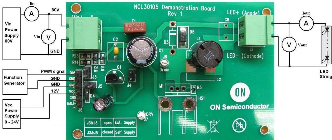
Figure 4 : Test Setup 3
