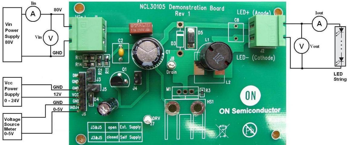
Figure 3 : Test Setup 2
