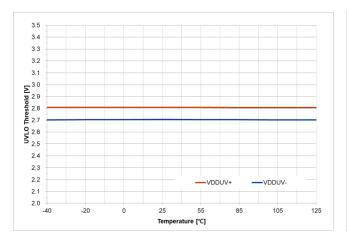
Figure 22.  $V_{\rm DD}$  UVLO vs. Temperature
