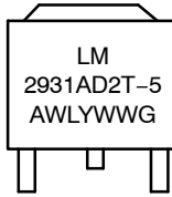
D2PAK D2T SUFFIX CASE 936
