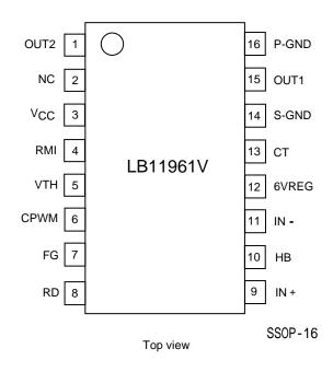
P-GND:モータ系GND S-GND:制御系GND
