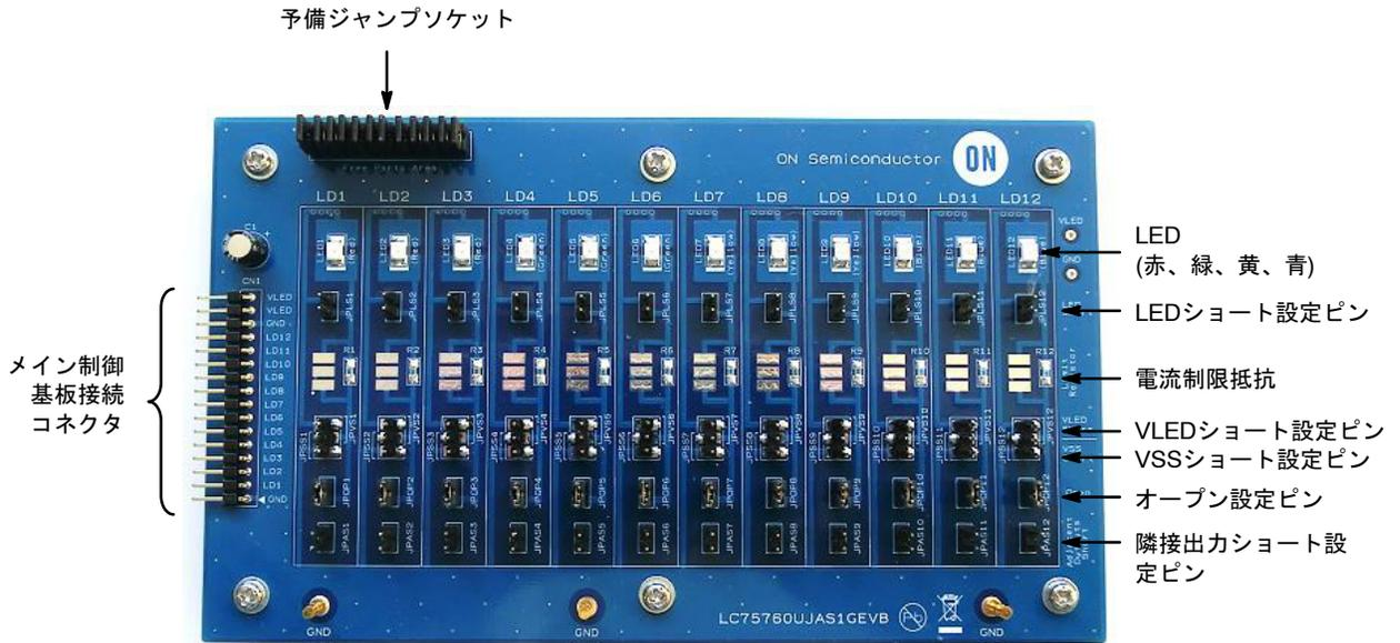
図 13. サブLED基板構成
