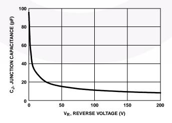
FIGURE 7. JUNCTION CAPACITANCE vs REVERSE VOLTAGE
