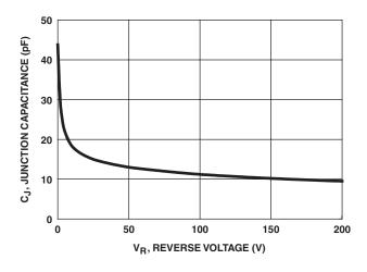
FIGURE 7. JUNCTION CAPACITANCE vs REVERSE VOLTAGE
