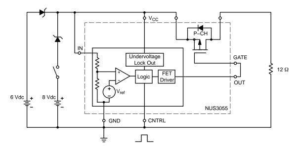
Figure 11. Test Circuit for  $T_{\mbox{\scriptsize ON CT}}$  and  $T_{\mbox{\scriptsize OFF CT}}$
