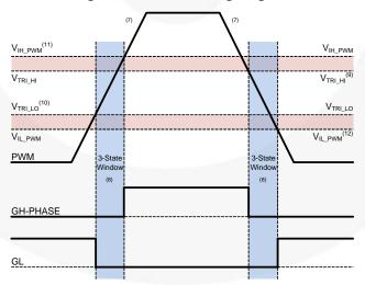
Figure 28. **PWM Threshold Definition**
