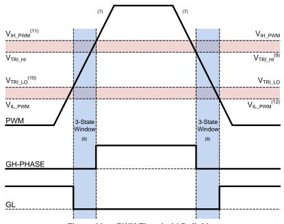
Figure 26. PWM Threshold Definition
