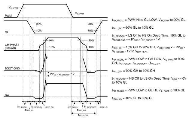
Figure 25. PWM Timing Diagram
